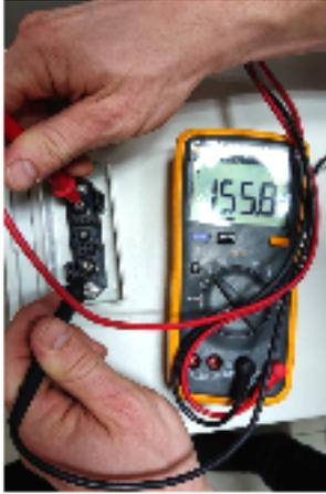
Se la tensione misurata si discosta significativamente dal valore nominale, controllare la tensione elettrica sui singoli moduli, come mostrato di seguito:
