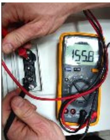
Se a tensão medida se desviar significativamente do valor nominal, verifique a tensão elétrica nos módulos individuais, conforme mostrado abaixo.
