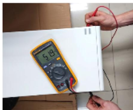
Um Módulo em que uma das células 32 (HVS) / 16 (HVM) tem uma tensão de <1,5 V está em subtensão (verifique com BCP (seção 2.5) / BC se possível).
