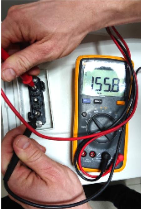
Wenn die gemessene Spannung erheblich vom Nennwert abweicht, überprüfen Sie bitte die elektrische Spannung an den einzelnen Modulen wie folgt:
